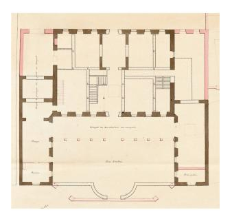
**6** Projet de transformation de la maison d'Herwarth en douane, par Henri Perregaux, 1817. Plan du rez-de-chaussée. Les pointillés indiquent le tracé des maçonneries à démolir (AC Vevey, GB bleu 47).
