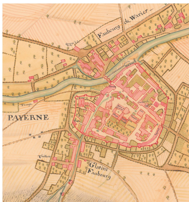
1 Adam Riediguer, géomètre, plan de 1724 (ACV, Gb 314/b). Un des grands intérêts de ce plan est de montrer de manière détaillée et précise le cheminement de l'eau dans les fossés, jardins et vergers, ainsi que le ruisseau du Corrençon, avec ses roues à aubes en Glatigny et son détournement à l'intérieur de la ville. On peut repérer également les principales fontaines et l'étang au pied du mur du temple.
