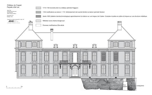
6 Façade côté lac avec les étapes de construction et orthophoto de la façade du corps de logis médiéval et de l'angle est (Archéotech SA sur la base des relevés Alain Félix. Orthophotos Archéotech SA).
