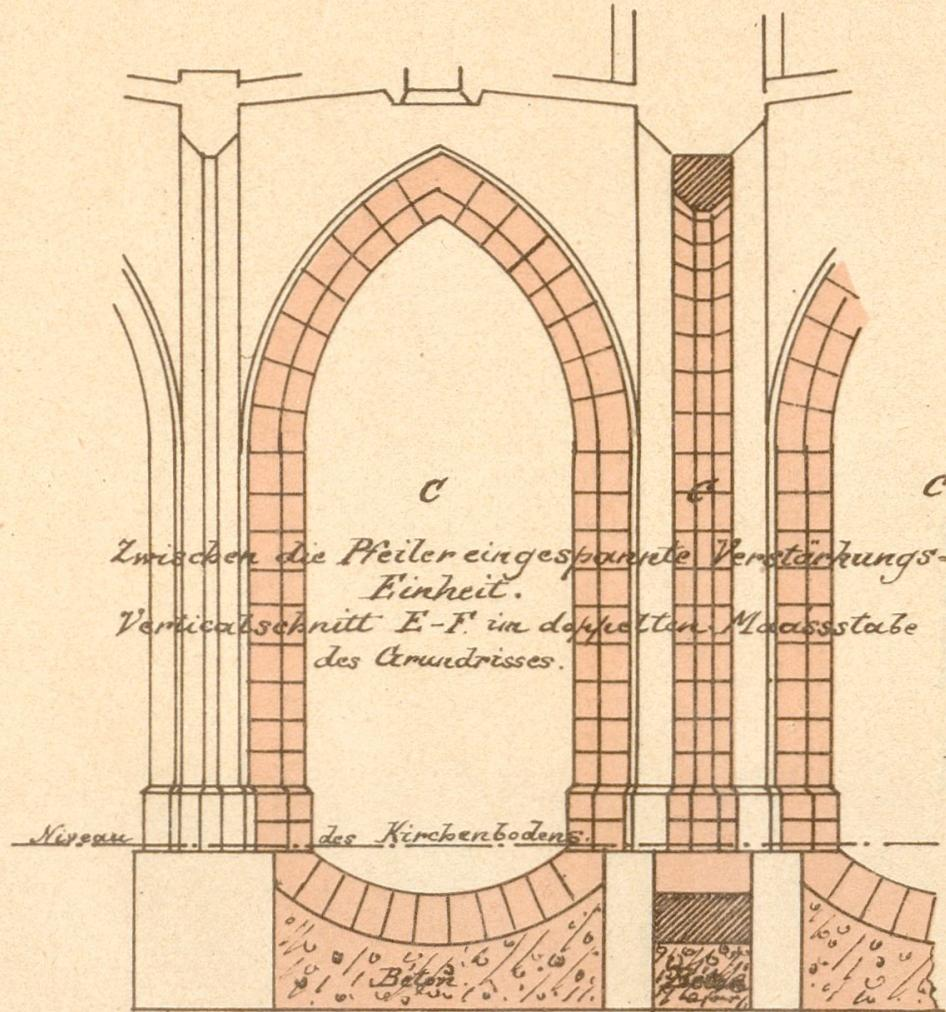
Zwischen die Pfeiler eingespannte Verstärkungseinheit.
