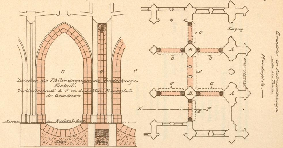
te Verstärkungs einheiten. — D. Ewishen den Pfeilern B besteht die Verstärkung nur aus einem umgekehrten Bogen zwischen den Fundamenten mit starken Betonlage darunter.
