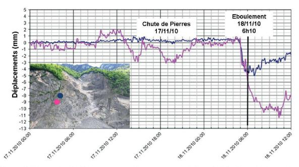
Figure 20.17.—Courbes de déplacement mesuré au sommet et à la base de l'éboulement intervenu le 18/11/2010 à 6h10. Cet éboulement de plaques superficielles a été précédé par quelques chutes de pierre le 17/11 et une accélération importante des mouvements sur une durée de 1 h avant l'éboulement final.
