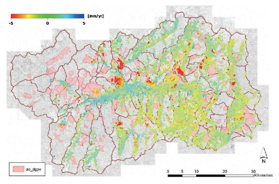
Figure 26.1.—Carte des vitesses et de la répartition des PS (orbite montante) dans la région du val d'Aoste (nord-ouest de l'Italie). Carte de base: périmètres de DGPV du projet IFFI (Inventaire des glissements de terrain italiens).
