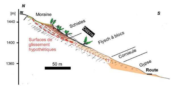
Figure 31.9.—Coupe schématique simplifiée au travers du glissement établie en 2006 avant l'évènement de 2007. Les surfaces de rupture (traits tillés rouges) sont purement spéculatives (Tiré de JABOYEDOFF 2006).
