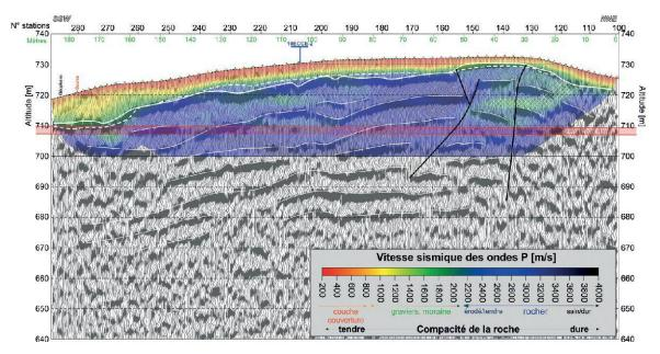
Figure 27.5.—Coupe de sismique hybride interprétée, dans l'axe de la conduite prévue (alt. 710 m). La ligne blanche supérieure indique le toit du rocher. Celui-ci est mis en évidence aussi bien par le champ de vitesse issu de la sismique réfraction que par l'image structurelle de la sismique réflexion. Les lignes blanches fines indiquent les limites de couche et une zone d'ameublissement au toit du projet (quadrillage). En noir, les principales failles sont nettement visibles.
