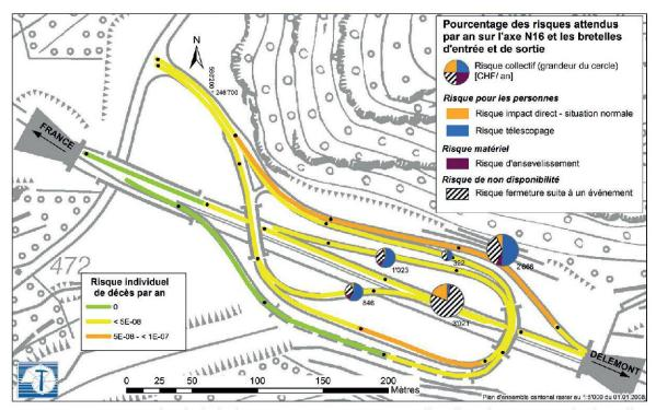
Figure 18.4.—Risque individuel de décès par tronçon et risque collectif sur l'axe N16 et les bretelles d'entrée et de sortie. Pour mémoire, le risque pour les personnes en situation bouchon et le risque de non disponibilité en cas de fermeture préventive sont considérés comme nuls.
