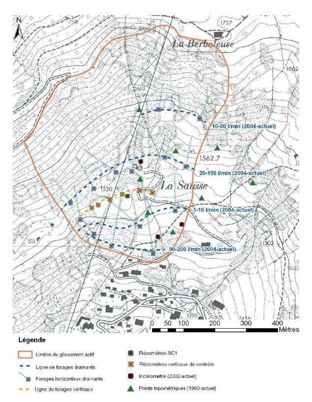
Figure 23.3.-Situation des mesures d'assainissement et du système de surveillance du glissement.
