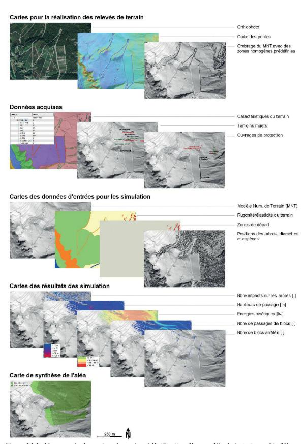
Figure 14.1.-Un exemple des cartes nécessaires à l'utilisation d'un modèle de trajectographie 3D.
