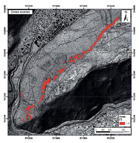
Figure 16.2.—Carte des zones de départ des blocs, pentes supérieures à 45°.
