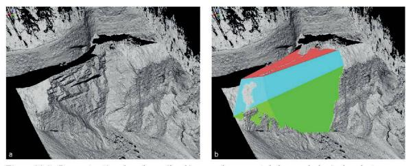
Figure 20.9.-Reconstruction du volume éboulé par prolongement de la morphologie des alentours.
