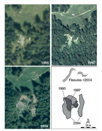
Figure 31.10.—Orthophotos de la partie supérieure du glissement pendant les 13 dernières années. Observez l'augmentation de la taille du secteur particulièrement entre 1997 et 2004. Quelques problèmes d'ortho-rectification existent entre les photos (données de swisstopo 2008 de SWISSIMAGE (DV012716)).
