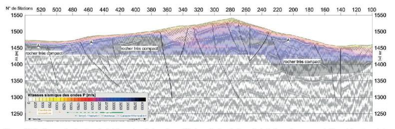
Figure 27.6.—Coupe de sismique hybride en terrain karstique. L'interprétation indique le toit du rocher compact (ligne blanche «A») identifié sur tout le profil de façon discontinue. De nombreuses failles (traits noirs) sont visibles ainsi que des zones d'ameublissement (quadrillage) à mettre en relation avec la présence de dolines en surface et de cavités karstiques.
