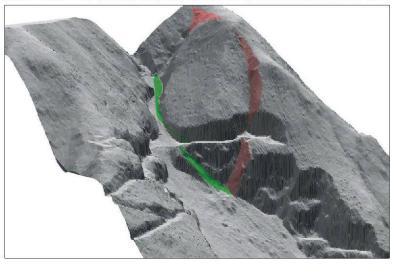
Figure 20.16.—Au-dessus de la zone éboulée en 2008, une zone potentiellement instable de 100 à 150'000 m³ a été identifiée. L'analyse géomorphologique et des forages de reconnaissance ont révélé la persistance des joints impliqués dans l'éboulement (J1 en rouge et J2 en vert).
