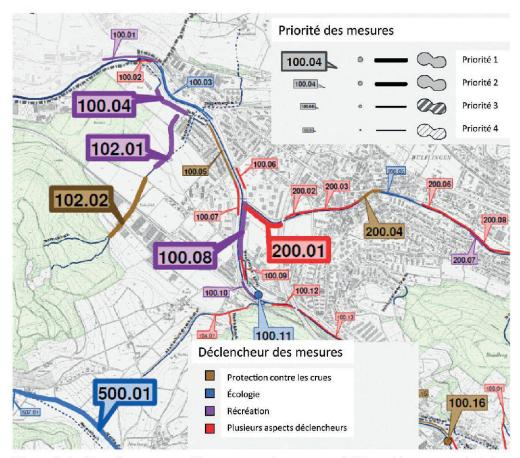
Figure 9.4.—Plan des mesures: Des paquets de mesures différenciées entre priorité et aspect déclencheur.
