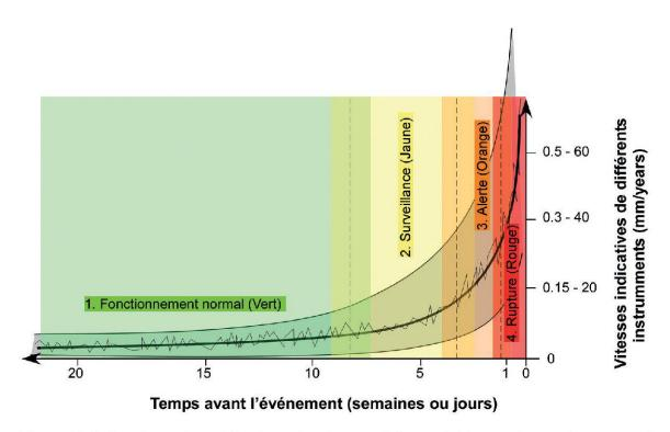
Figure 32.6.—Représentation schématique des niveaux d'alerte relatifs aux vitesses de capteurs de mouvement. Notez que les périodes de décision sont floues en fonction des connaissances d'expert et que les valeurs seuils sont définies en fonction du capteur et de sa position (Modifié d'après FROESE et al. 2012; d'après BLIKRA 2008 et FROESE & MORENO 2011).
