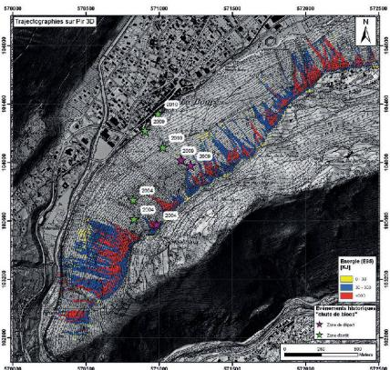
Figure 16.3.—Résultats des simulations trajectographiques sur PiR3D.
