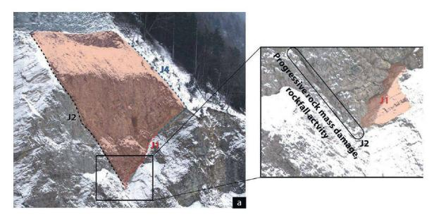
Figure 20.11.—Zone du dièdre potentiellement instable avec extension maximale supposée du dièdre délimité par J1 et J2. La zone encadrée indique une zone présentant une activité importante.
