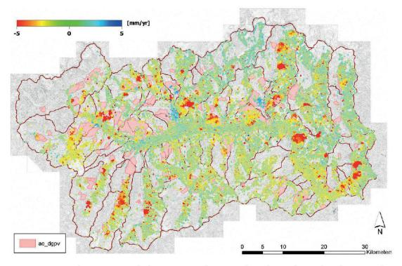
Figure 26.2.—Carte des vitesses et de la répartition des PS (orbite descendante) dans la région du val d'Aoste (nord-ouest de l'Italie). Carte de base: périmètres de DGPV du projet IFFI (Inventaire des glissements de terrain italiens).
