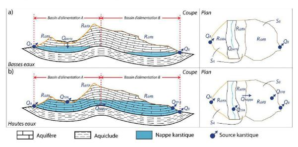
Figure 6.1.—Flux aux limites de deux systèmes karstiques contigus en situation de basses eaux et de hautes eaux, en coupe et en plan. Le bilan hydrologique du bassin B en basses eaux s'entend comme  $R_{diffB} = Q_B$ . En hautes eaux, ce même bilan s'écrit  $R_{diffB} + Q_{nappe} = Q_B + Q_{TPB}$ .
