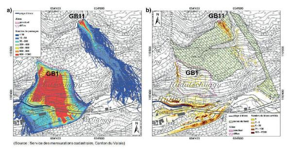
Figure 15.4.— Gondobrücke (Zwischbergen, VS): a) Carte du nombre de passages de blocs par cellule; b) Carte du nombre de blocs arrêtés par cellule.
