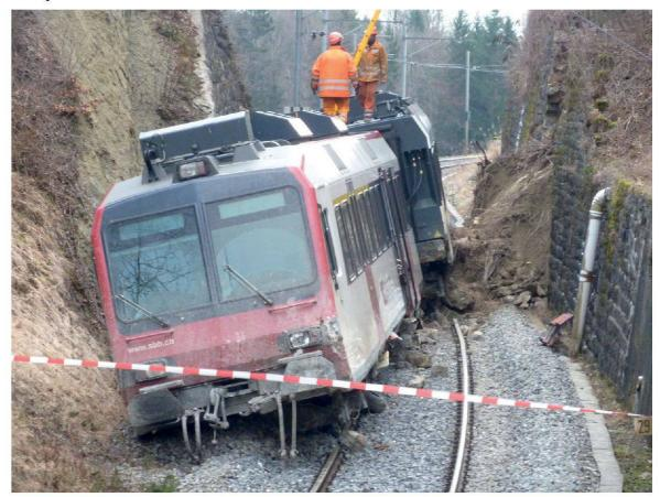
Figure 4.-Train qui a déraillé en février 2013, avec le mur qui à cédé et le dépôt des matériaux.
