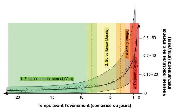
Figure 6.—Représentation schématique des niveaux d'alerte relatifs aux vitesses de capteurs de mouvement sur des glissements rocheux de plusieurs millions de m³. Notez que les périodes de décision sont floues en fonction des connaissances d'expert et que les valeurs seuils sont définies en fonction du capteur et de sa position (Modifié d'après FROESE et al. 2012; d'après BLIKRA 2008 et FROESE & MORENO 2011). (figure 32.6 en couleur en annexe)
