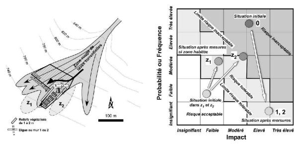
Figure 8.—Exemple de zone à bâtir potentielle dans une zone d'aléa élevé et illustration des solutions proposées. A droite représentation des degrés de risques à l'aide de la matrice impact-fréquence. Le champ du risque tolérable (gris clair) est compris entre la limite du risque tolérable et celle du risque inacceptable.
