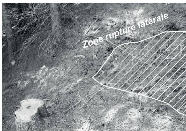
Figure 13.–Vue de la zone rupture qui s'initiait en juin 2009, qui annonce la rupture d'août 2010.
