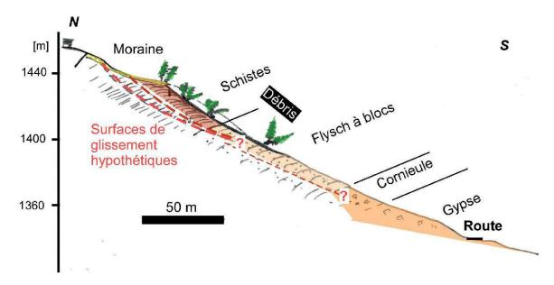
Figure 9.—Coupe schématique simplifiée au travers du glissement établie en 2006 avant l'évènement de 2007. Les surfaces de rupture (traits tillés rouges) sont purement spéculatives (Tiré de JABOYEDOFF 2006).
