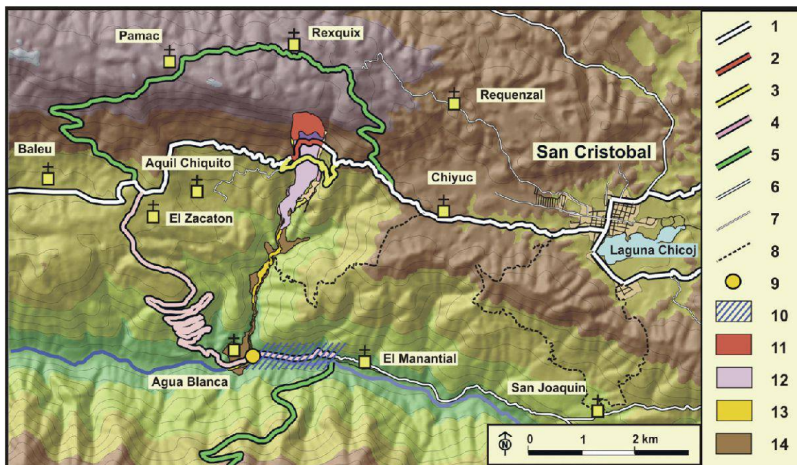
Figure 2.—Dommages causés par l'avalanche rocheuse du 4 janvier 2009 à la route 7W, et tracés de rechange proposés ou réalisés. 1- Tracé de la route 7W avant l'avalanche, 2 – Segment détruit, 3 – piste ouverte et maintenue par les communautés locales sur les dépôts d'avalanche, 4 – piste de rechange réalisée par le gouvernement sur avis d'expert en réponse d'urgence à la coupure de la route 7W, 5 – autres itinéraires de contournement proposés, 6 – pistes principales, 7 – pistes secondaires desservant les communautés, 9 – lieu de coupure de la piste (4) par les laves torrentielles, 10 – segment de la piste (4) inondé du fait du barrage de la rivière Chixóy, 11 – niche d'arranchement du 4 janvier 2009, 12 – dépôt d'avalanche associé, 13 – dépôts de laves torrentielles en juin 2009, 14- dépôts d'avalanche et de laves torrentielles produits par deux avalanches anciennes de même magnitude durant les derniers 8000 ans.
