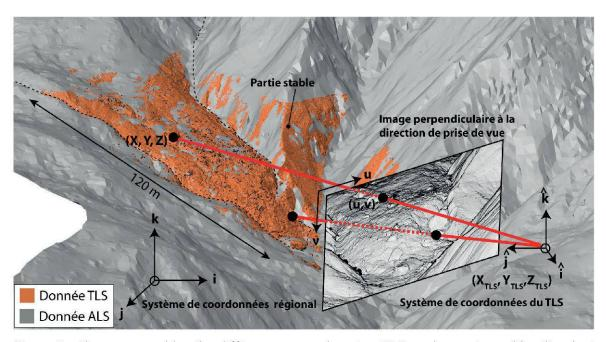
Figure 2.—Alignement en bloc des différents nuages de points TLS sur les parties stables d'un levé ALS. Transformation projective appliquée sur les nuages de point avec les différents systèmes de coordonnées impliqués dans la procédure.
