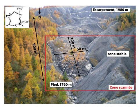
Figure 1.—Vue du glissement de Super-Sauze depuis la station de base TLS en direction du Sud. La photographie correspond au plan perpendiculaire à la direction de vue du scanner. La zone scannée inclut le pied du glissement et la zone stable.
