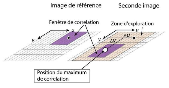
Figure 4.-Principe de la corrélation d'images (adapté de TRAVELLETTI et al. sous presse).
