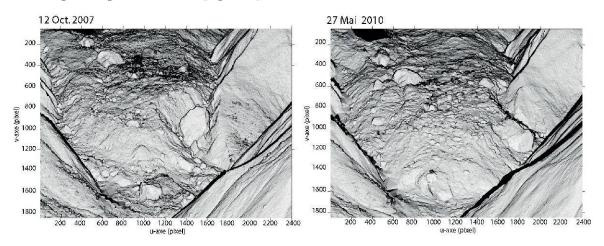
Figure 3.—Exemple d'images (première et dernière acquisition TLS) générées à partir du gradient de la distance (points – station TLS) pour la corrélation.
