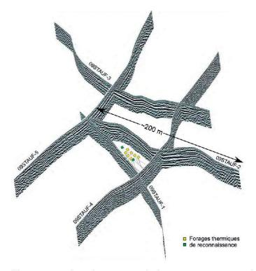
Figure 9.—Les cinq profils sismiques d'une longueur totale de 1400 m acquis à Staufen sont représentés en 3D.
