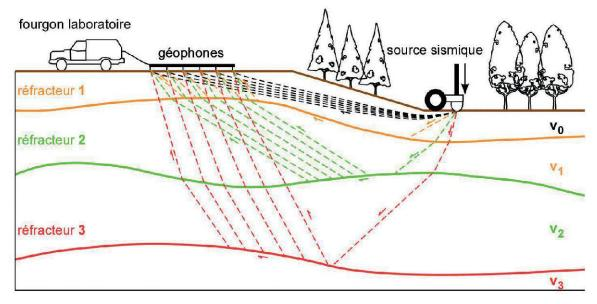
Figure 2.-Dispositif de mesure et propagation des ondes pour la sismique réfraction.
