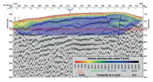
Figure 5.—Coupe de sismique hybride interprétée, dans l'axe de la conduite prévue (alt. 710 m). La ligne blanche supérieure indique le toit du rocher. Celui-ci est mis en évidence aussi bien par le champ de vitesse issu de la sismique réfraction que par l'image structurelle de la sismique réflexion. Les lignes blanches fines indiquent les limites de couche et une zone d'ameublissement au toit du projet (quadrillage). En noir, les principales failles sont nettement visibles.
