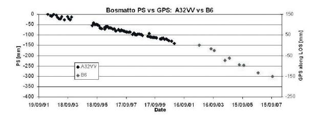
Figure 6.—Glissements de terrain de Bosmatto: trois exemples de données GPS (après 2001) projetées le long de la LOS du satellite comparées aux données PS correspondantes (avant 2001). Bosmatto landslide: three examples of GPS data (after 2001) projected along satellite LOS compared with corresponding PS time series (before 2001).
