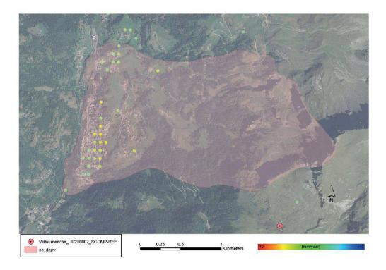
Figure 3.-Vitesse annuelle moyenne de déplacement horizontal est-ouest (en haut) et vertical (en bas) pour un cas d'étude historique obtenue en combinant les LOS (Line of Sight) ascendantes et descendantes des déplacements PS.
