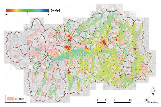
Figure 1.—Carte des vitesses et de la répartition des PS (orbite montante) dans la région du val d'Aoste (nord-ouest de l'Italie). Carte de base: périmètres de DGPV du projet IFFI (Inventaire des glissements de terrain italiens).
