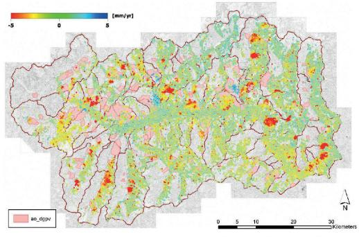
Figure 2.—Carte des vitesses et de la répartition des PS (orbite descendante) dans la région du val d'Aoste (nord-ouest de l'Italie). Carte de base: périmètres de DGPV du projet IFFI (Inventaire des glissements de terrain italiens).
