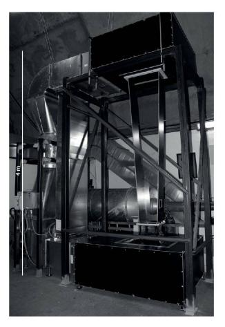
Figure 4.—La soufflerie verticale pour l'étude de la vitesse terminale et de l'agrégation des particules; The wind tunnel for the study of terminal velocity and aggregation of volcanic particles.
