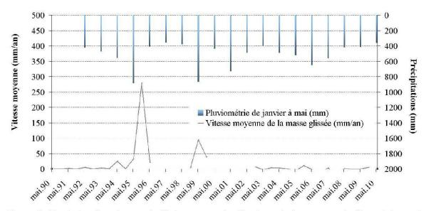
Figure 5.-Evolution des vitesses de déplacement calculées à partir des mesures inclinométriques à l'aval du glissement (d'après CSD Ingénieurs SA, 1991-2010).
