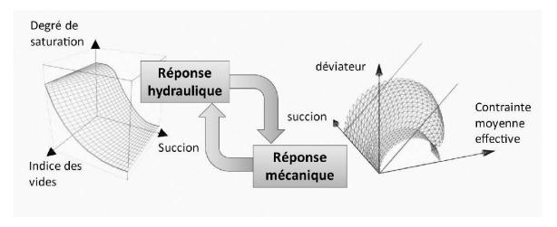
Figure 2.—Concept du couplage hydromécanique — Modèle ACMEG de l'EPFL. Un modèle de rétention d'eau permet de décrire l'évolution de la succion en fonction du degré de saturation en eau dans le sol (gauche). L'influence de la succion sur le comportement mécanique du sol (notamment une résistance au cisaillement plus élevée) est considérée entre autre au niveau de la loi constitutif par le biais d'une surface de charge qui évolue avec la succion (droite).
