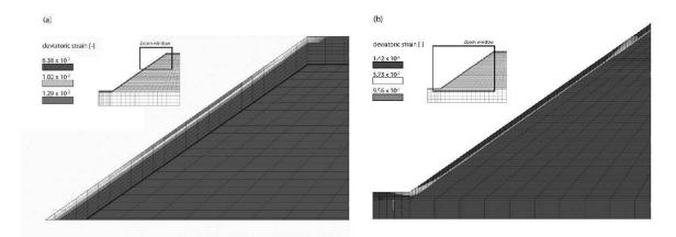
Figure 7.—Déformations déviateurs correspondant aux mécanismes de rupture les plus probables. (a) Mécanisme de rupture superficiel pour une faible conductivité hydraulique ( $k_{sat} = 10^{-6}$  m/s) indiqué par les variations importantes de déformations de cisaillement; (b) Localisation des déformations le long de l'interface entre le substratum quasiment imperméable et le colluvium ( $k_{sat} = 10^{-4}$  m/s).
