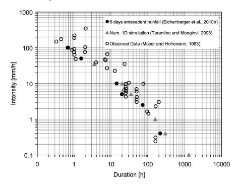
Figure 6.—Couples d'intensité-durée de pluie critique pour la stabilité de versants selon les calculs numériques 2D (EICHENBERGER *et al.* 2010b), l'analyse 1D de TARANTINO & MONGIOVI (2003) et les observations in-situ par MOSER & HOHENSINN (1983).
