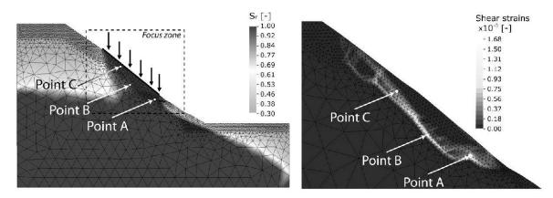
Figure 4.—Infiltration d'eau dans une pente partiellement saturée (gauche); Contours des déformations déviateurs après 3.5 jours d'infiltrations. Les zones claires indiquent une concentration des déformations de cisaillement et permettent l'identification d'un mécanisme de rupture (droite).
