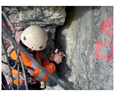
Figure 12.—Pose d'un fissuromètre (Bolozon); photo  ${\rm BG}\,/\,{\rm Hugues}$  Foltzer.
