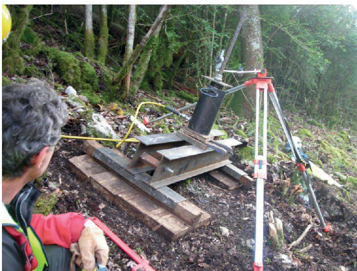
Figure 15.—Test de traction sur ancrage de filet 3000 kJ (Sylans); photo BG / Hugues Foltzer.
