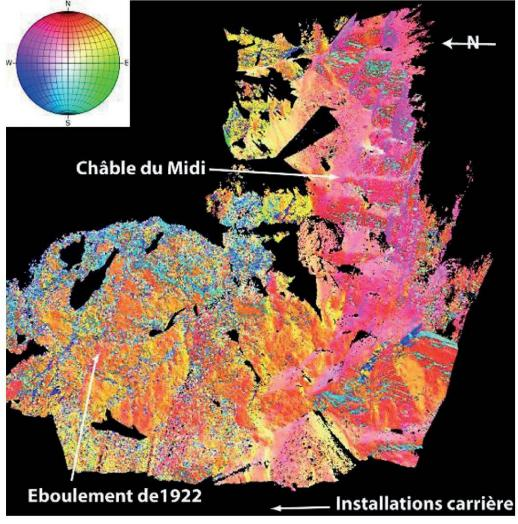
Figure 3.-Représentation Coltop3D du nuage de points SLT de la zone supérieure. Une couleur unique est attribuée à chaque orientation (Azimut/pendage). Stéréonet en hémisphère inférieur.
