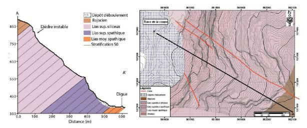
Figure 2.-Carte géologique montrant les différentes lithologies et structures en présence (en haut). Coupe simplifiée au niveau du Châble de Midi (en bas).
