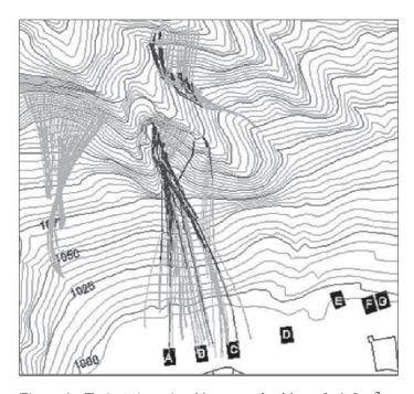
Figure 2.-Trajectoires simulées pour des blocs de 2,5 m<sup>3</sup>.
