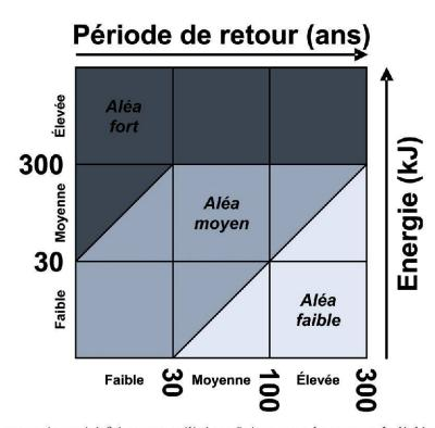
Figure 1.—Diagramme intensité-fréquence utilisé en Suisse pour le zonage de l'aléa chutes de blocs (tiré de OFAT OFEE OFEFP 1997).
