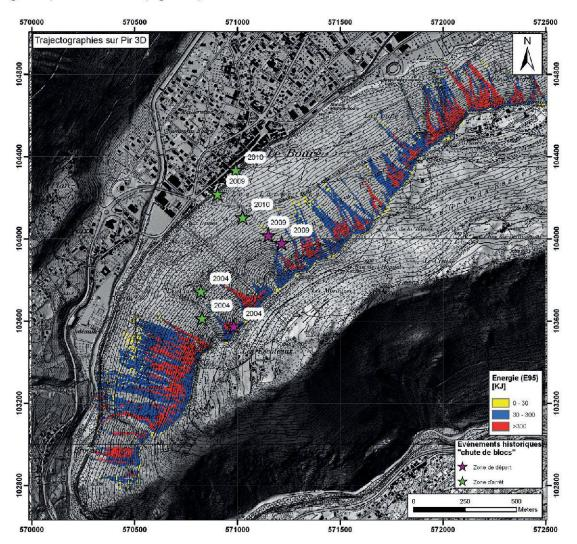
Figure 3.-Résultats des simulations trajectographiques sur PiR3D.
