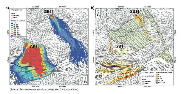
Figure 4.— Gondobrücke (Zwischbergen, VS): a) Carte du nombre de passages de blocs par cellule; b) Carte du nombre de blocs arrêtés par cellule.
