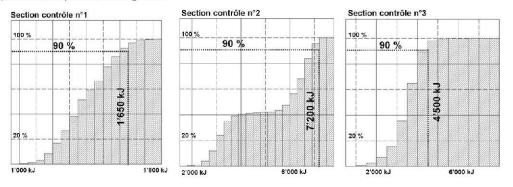
Figure 3.—Exemples de résultats statistiques de l'énergie cinétique des blocs le long d'un profil trajectographique 2D pour 3 sections de contrôle. (a) Variation du type de distribution des valeurs par classes et (b) lecture du quantile d'énergie E90.
