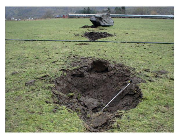
Figure 2.—Photo illustrant que la profondeur de pénétration doit être prise en compte dans le calcul de trajectoires, en particulier dans le cas d'un sous-sol mou (Photo: T. Vernang, NGI). Photo showing that the impact depth should be taken into account in the calculation of the rebound, in particular in cases of a soft underground (Photo: T. Vernang, NGI).
