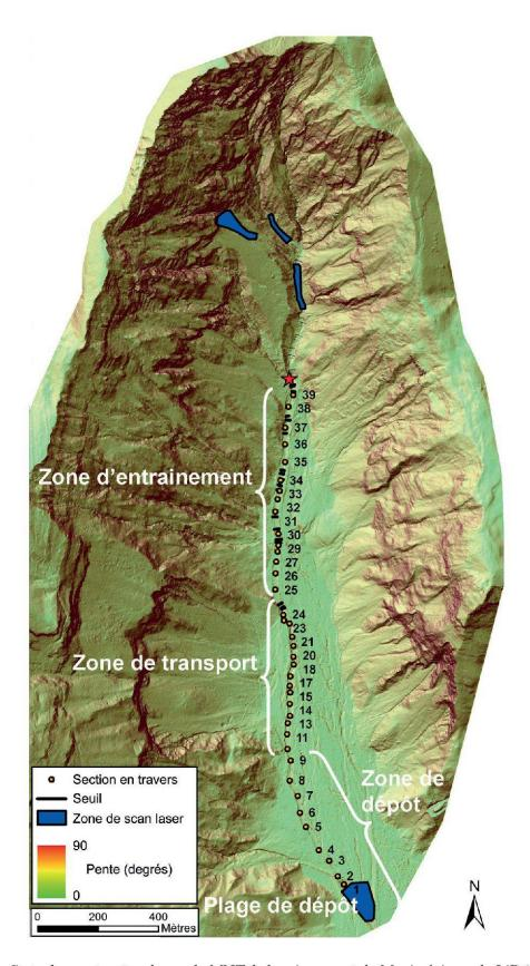
Figure 2.—Carte des pentes et ombrage du MNT du bassin versant du Manival, issue du LiDAR aérien, sur laquelle est reportée l'emplacement des sections étudiées, des barrages et de la zone de déposition.
