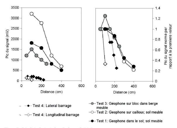
Figure 8.-Résultats des tests des géophones de 1 à 4.
