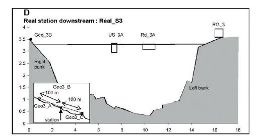
Figure 4.—Suite. Instrumentation en place sur l'observatoire du Réal (Alpes Maritimes, commune de Péone). (A) Localisation et photos des différentes stations du torrent du Réal; (B) Matériel de mesure à la station amont; (C) à la station du milieu: (D) à la station aval. Notations: Cam: camera, RG: pluviomètre; US: ultrason, Rd: radar, Geo: géophone. Les axes 'x' et 'y' sont en mètre (NAVRATIL et al. in press).
