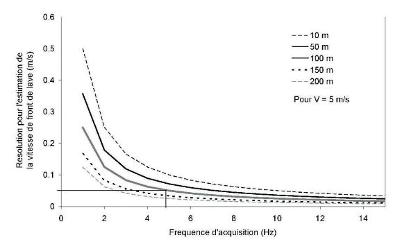
Figure 9.—Abaques pour l'estimation de la résolution de la vitesse de propagation de la lave en fonction de la fréquence d'échantillonnage au niveau de la Campbell (pour un front de lave se déplaçant à environ 5m/s).
