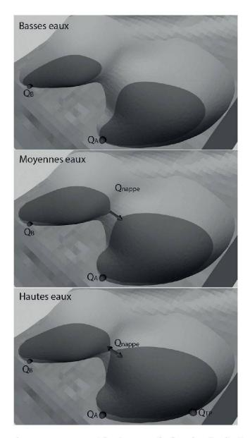
Figure 3.—Situation en basses, moyennes et hautes eaux de deux bassins limitrophe séparés par un seuil souterrain. Le volume visible représente l'aquiclude des deux systèmes. Le volume aquifère a été effacé afin de permettre une meilleure visualisation de la nappe.
