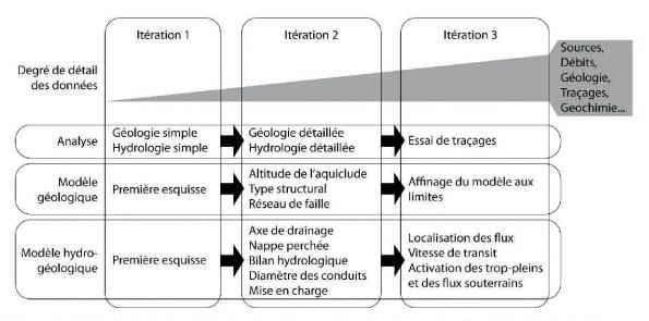
Figure 2.-Méthode itérative d'évaluation d'un système karstique. Le degré de détail de l'analyse progresse avec les itérations.
