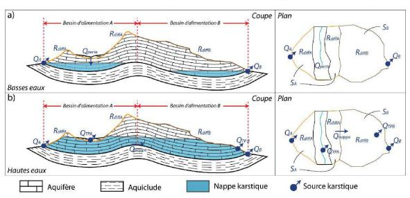
Figure 1.—Flux aux limites de deux systèmes karstiques contigus en situation de basses eaux et de hautes eaux, en coupe et en plan. Le bilan hydrologique du bassin B en basses eaux s'entend comme  $R_{diffB} = Q_B$ . En hautes eaux, ce même bilan s'écrit  $R_{diffB} + Q_{nappe} = Q_B + Q_{TPB}$ .
