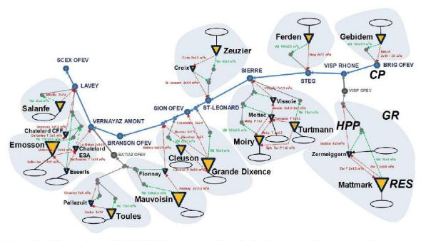
Figure 6.—Schéma du modèle MINDS avec le système hydraulique complexe et ses éléments: les réservoirs RES, les systèmes de vidange VID de fond (lignes traits-tillés) et les déversoirs, les centrales hydroélectriques de turbinage et pompage (lignes pointillées), le réseau principal et les points de contrôle (CP).
