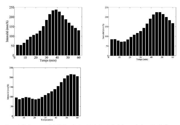
Figure 1.—Hyétogramme de la PMP sur trois points du terrain (la distance entre les points 1km). PMP histogram in three points of the terrain (distance between the points 1 km).
