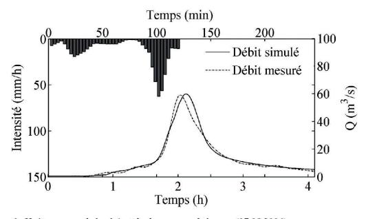
Figure 6.—Hyétogramme de la pluie et hydrogramme de la crue (07.08.2004). Hyetograph of the rain and the flood hydrograph (07.08.2004).
