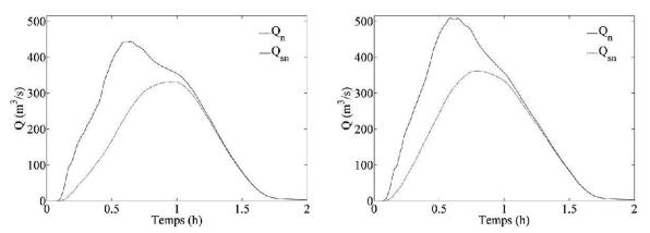
Figure 11.—Hydrogramme de crue PMF. Direction vent: nord (à gauche), est (à droite).  $Q_n$  représente le débit avec la fonte des neiges,  $Q_{sn}$  celui sans la fonte.
