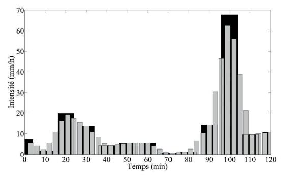
Figure 5.—Hyétogramme de la pluie (07.08.200). Hyetograph of the rain (07.08.2004).
