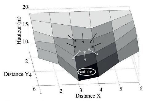
Figure 3.—Distribution de ruissellement pour une cellule de terrain. Runoff distribution for a terrain cell.
