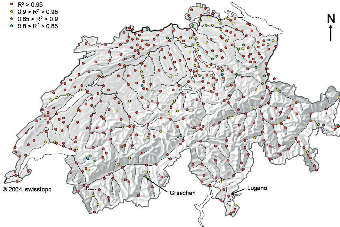
Figure 2.—Coefficients de détermination R^2 pour les droites d'ajustement de Gumbel pour les précipitations journalières maximales par an en Suisse.
