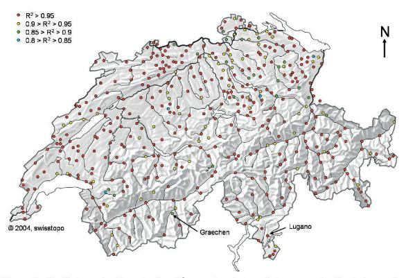
Figure 2.-Coefficients de détermination R<sup>2</sup> pour les droites d'ajustement de Gumbel pour les précipitations journalières maximales par an en Suisse.
