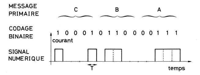
Figure 3. – Traduction d'un message codé en un signal représentatif.
