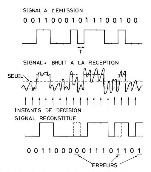
Figure 8. – Influence du bruit sur un système de transmission d'informations.
