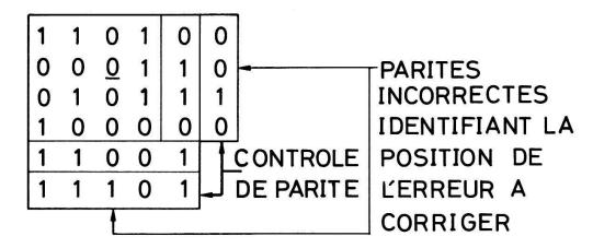
Figure 9. – Code géométrique corrigeant une erreur isolée.
