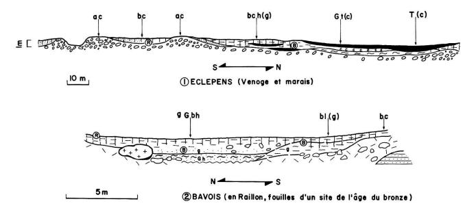
Fig. 42. – Séquence dans les dépôts alluviaux à Eclépens (1) et colluviaux à Bavois (2) B et R indiquent des niveaux archéologiques de l'âge du bronze et romain.
