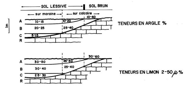
Fig. 29. – Ecarts granulométriques moyens dans les sols avec placage morainique d'épaisseur croissante sur substrat de calcaire crétacé au pied du Jura.
