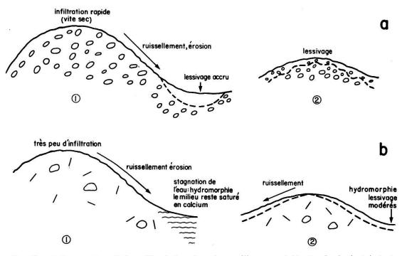
Fig. 13. – Influence du relief sur l'évolution du sol en milieu perméable, (a: fluvioglaciaire) et en milieu peu perméable (b: moraine de fond)
