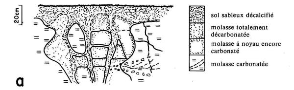
Décarbonatation dans la molasse grèseuse: c'est une décarbonatation irrégulière, des noyaux à ciment plus abondant résistent plus longtemps, elle pénètre plus profondément dans les fissures.
