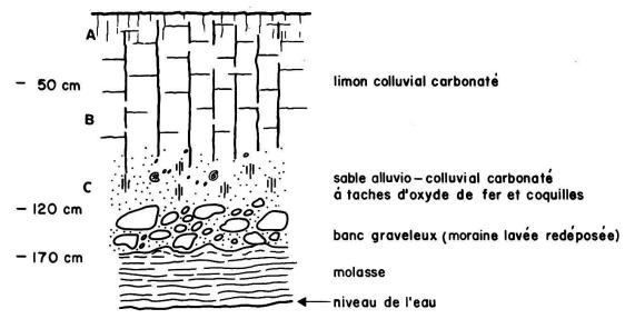
Fig. 20. – Coupe du ruisseau de Sadaz à Chavornay (Sol brun calcaire alluvio-colluvial)
