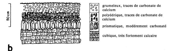
Décarbonatation dans la molasse marneuse: c'est une décarbonatation progressive qui affecte l'ensemble du matériau régulièrement structuré.
