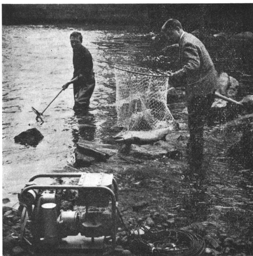
Fig. 1.— L'appareil de pêche électrique employé dans la présente étude.
