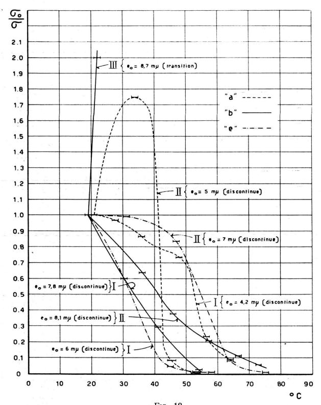
Fig. 19. Effet de la température sur des lames d'argent (a - b) - (e).
