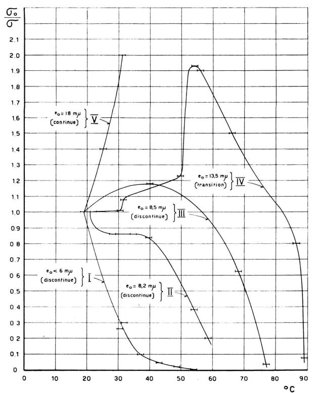
Fig. 18. — 1er diagramme. Effet de la température sur des lames d'argent «c».
