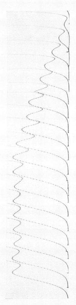
Fig. 15. — Hauteur de la vague catalytique en fonction de la concentration du Prolan. pH 8,0, KCl 0,5 n, tampon  $PO_4$  m/30. De gauche à droite, concentrations de : 110 100 90 80 70 60 50 40 30 20 16 12 10 8
