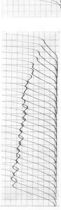
Fig. 12. — Reproductibilité de la vague catalytique de la gonadotrophine CIBA. Douze concentrations ont été préparées à partir de pesées différentes et enregistrées côte à côte. S 1/300, KCl 0,5 n, tampon PO<sub>4</sub> m/30, pH 7,5.
