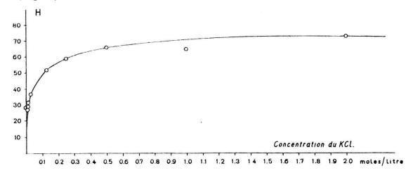
Fig. 4. — Hauteur de la vague polarographique de 6,7 UI/2 cc de Prolan en fonction de la concentration du KCl. (Sensibilité S 1/100).
