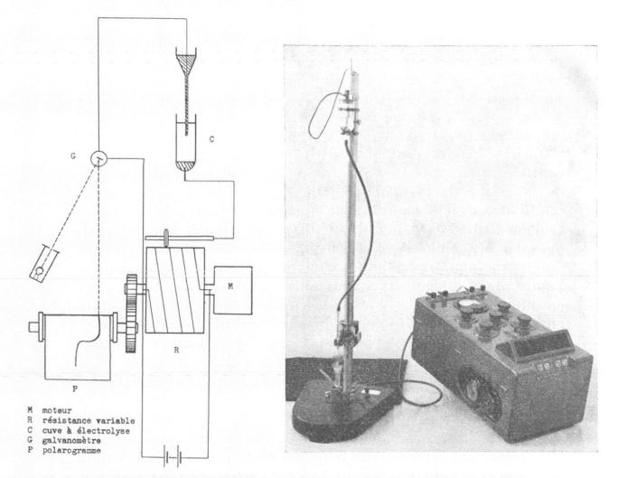
Fig. 1. — Schéma du polarographe. Fig. 2. — Le polarographe «Cambridge».
