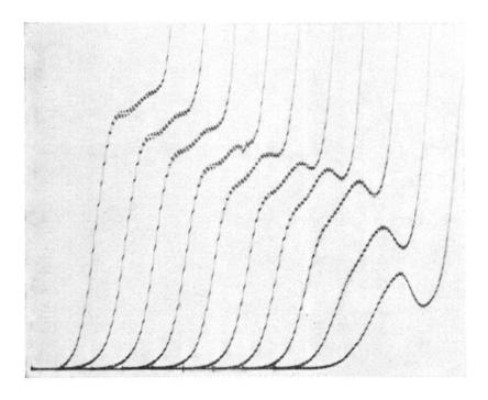
Fig. 9. — Influence de la concentration sur la hauteur et la forme de la vague de 6,7 UI/2cc de Prolan. Tampon PO<sub>4</sub> 0,4 n à gauche, 0,025 n à droite. S 1/300. pH 8,1. KCl 0,5 n.
