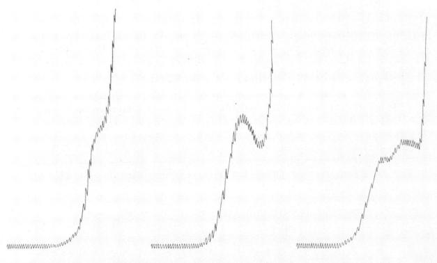
Fig. 7. — Les différents types de vague catalytique. A gauche : « Prenatrium wave » ; au milieu : « Simple wave » ; à droite : « Double wave » .
