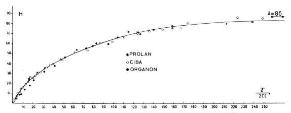
Fig. 23 — Hauteur de la vague des trois gonadotrophines étudiées, en fonction de la concentration exprimée en γ/2 cc. Conditions standard de mesure.
