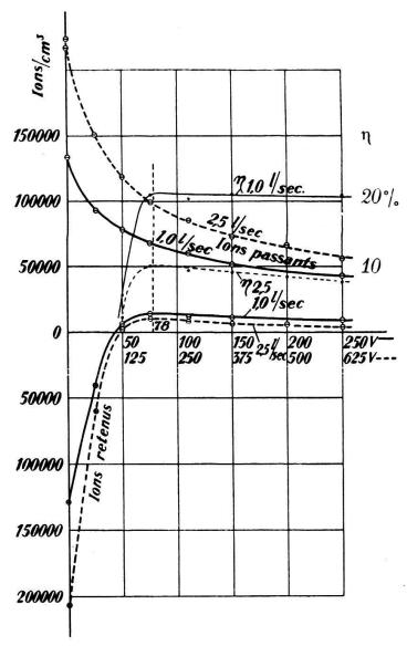
Fig. 17. — Courbes de séparation des ions en fonction de la tension de séparation.
