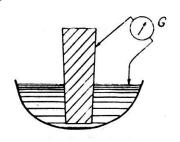
Fig. 10. — Reproduction en laboratoire du phénomène P. S. électrocapillaire à l'aide d'un fragment de terre réfractaire.
