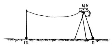
Fig. 11. — Dispositif utilisé pour une mesure P. S. m n = contact des électrodes impolarisables avec le sol.
