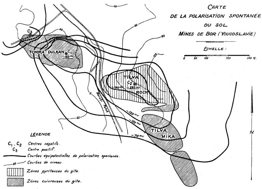
Les parties hachurées de la carte indiquent une section des amas à un niveau inférieur au niveau hydrostatique.
