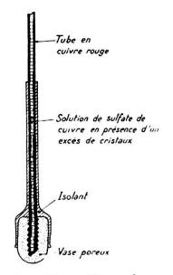
Fig. 12. — Electrode impolarisable type Schlumberger.
