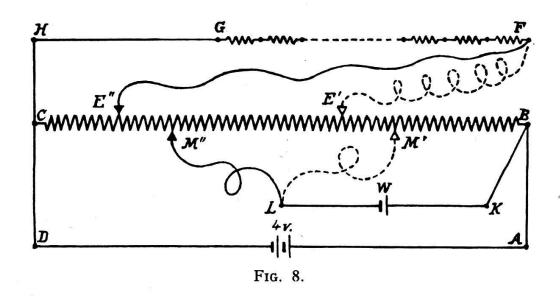
Suivant la position du contact E, on peut obtenir entre H et F des différences de potentiel d'ordres très différents. Il est facile de calculer deux positions E' et E'' de E, telles que le rapport des courants qui passent dans les tronçons E'FGHC et E''FGHC soit dix à un (fig. 8). D'où, pour l'appareil, deux sensibilités, l'une dix fois supérieure à l'autre.
