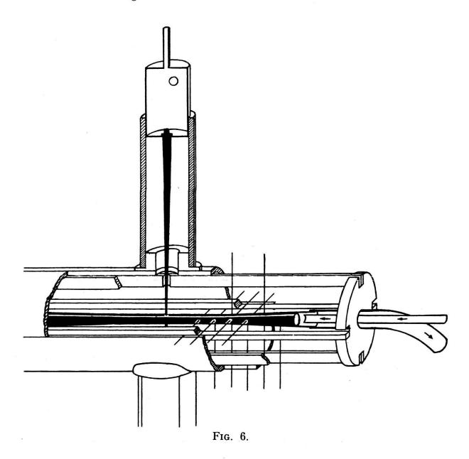
En outre, pour compenser les assymétries de températures, des dérivations permettent d'introduire de place en place des courants supplémentaires.
