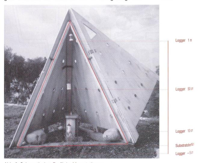
Abb. 3: Schematisches Profil der Messstationen
