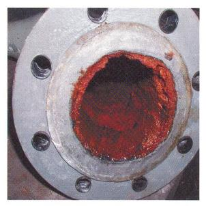
Abb. 4: Metallrohr, betrieben mit Meerwasser als Kühlmedium
