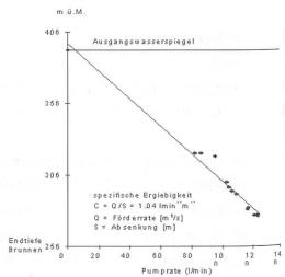
Abbildung 5: Leistungscharakteristik des Vertikalfilterbrunnens 98-378B1 im Muschelkalkaguifer.
