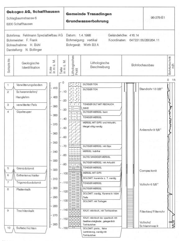
Abbildung 4: Bohrprofil der Grundwasserbohrung Trasadingen 98-378-B1.
