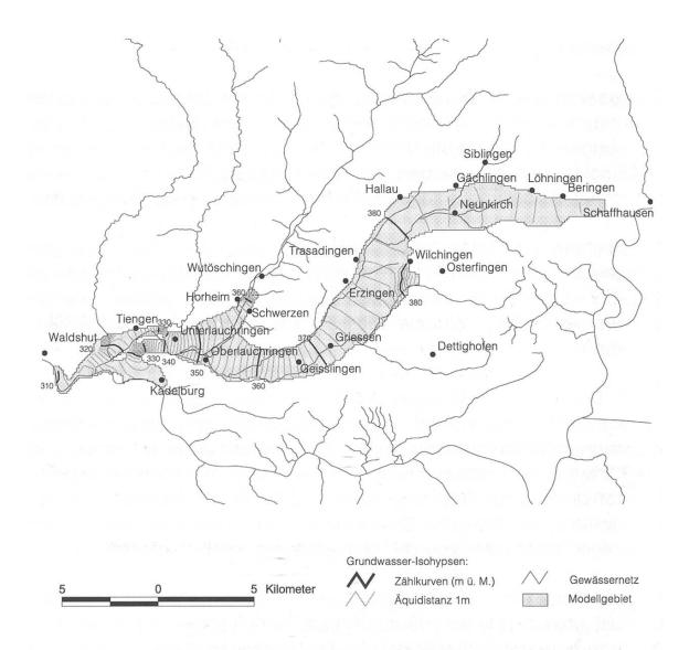
Abbildung 3: Berechnete Isohypsen des Grundwasserspiegels für den Hauptstichtag 6. November 1989 aufgrund der Kalibrierung 1998
