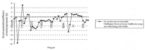
Abbildung 7: Vergleich der für den Stichtag 25. April 1988 berechneten Grundwasserstände mit den entsprechenden Messwerten.
