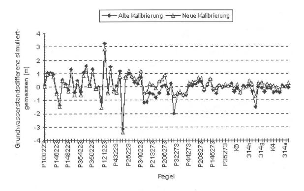
Abbildung 4: Grundwasserspiegeldifferenz (berechnet minus gemessen) für den Hauptstichtag 6. November 1989 an den Messpegeln in einem Profil von West nach Ost. Vergleich der alten Kalibrierung 1993 mit der neuen Kalibrierung 1998.
