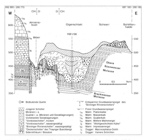
Abbildung 4: Übersichtsprofilschnitt durch die Binninger-Rinne (10 x überhöht)
