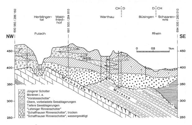
Abbildung 5: Übersichtsprofilschnitt durch den Schaffhauser-Rinnenschotter (10 x überhöht)
