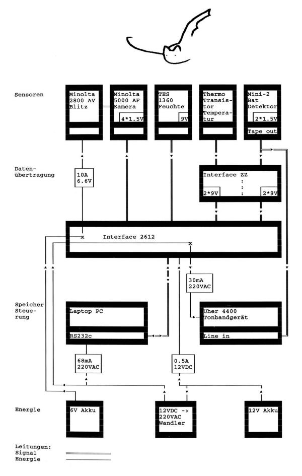
Abbildung 1: Messstation. Schematische Darstellung der Anordnung und Verbindung der einzelnen Komponenten.
