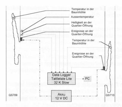
Abbildung 1: Anordnung, Verdrahtung und Funktion der verschiedenen Komponenten.
