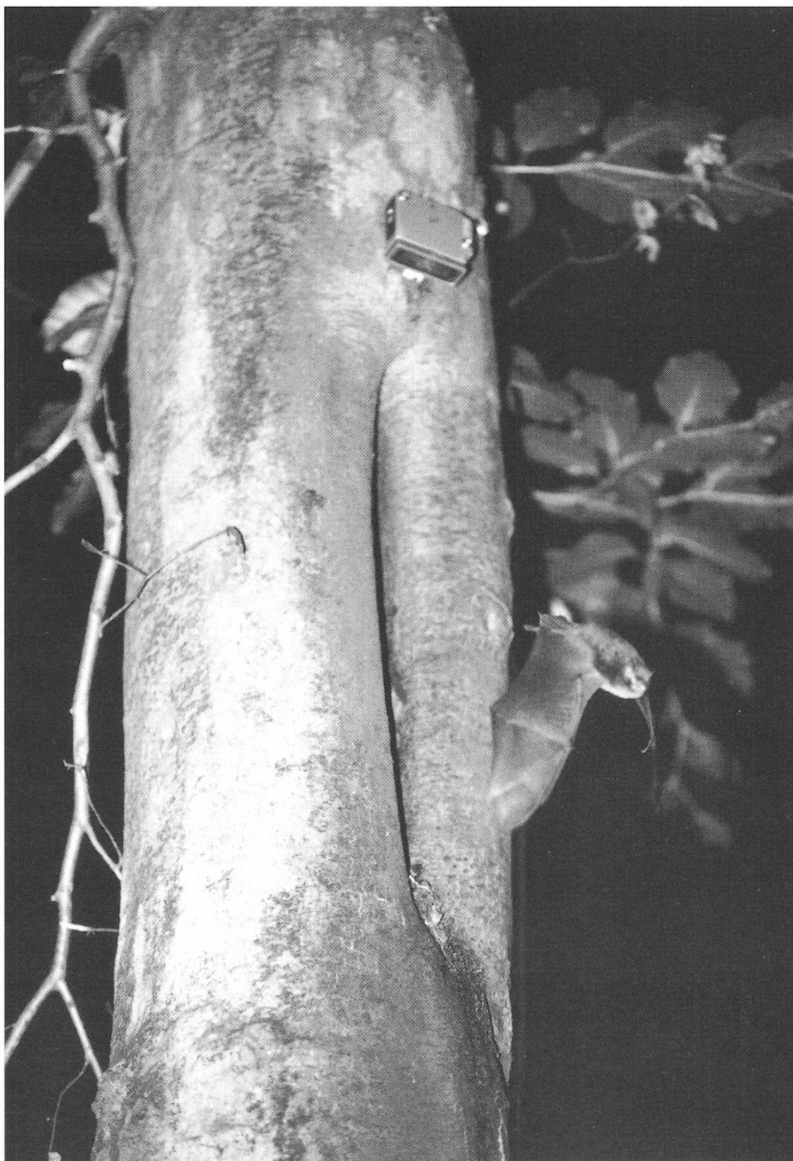
Eine Wasserfledermaus verlässt in der Abenddämmerung das Quartier QS709 (Rotbuche mit Aufrisshöhle). Die Infrarot-Reflexlichtschranke oberhalb der Spaltöffnung registriert den Ausflug, leitet diese Information an den Data Logger weiter und löst gleichzeitig den Photoapparat aus (siehe Seite 119, Aufnahme: HANSUELI ALDER).
