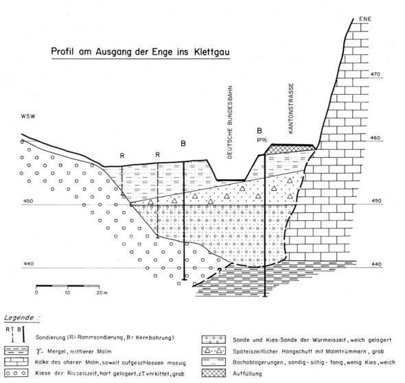
Fig. 4: Profil am Ausgang der Enge ins Klettgau, 2-fach überhöht
