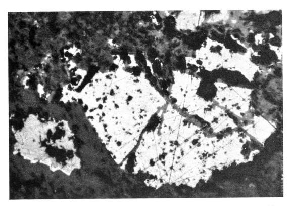
Abb. 4: Bornit (klein, dunkler) und Fahlerz (heller u. grösser) in Dolomit (dunkelgrau). N Villingen (5). — Anschliff, Vergrösserung 170×.
