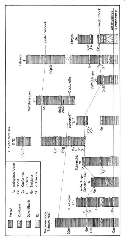
Abb. 2: Profilzug durch einige untersuchte Erzvorkommen. Vgl. mit Abb. 1. Die Zahlen entsprechen den Fundstellennummern im Text.
