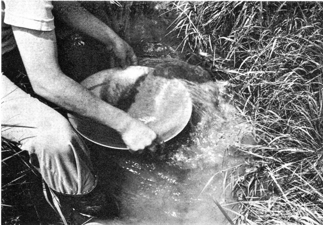
Abb. 3: Waschvorgang mit einer flachkonischen Pfanne französischer Provenienz. Durch wiederholte Schwenkbewegungen wird mit dem Wasser in der Pfanne der leichte Sand weggespült, während die schweren Mineralien zurückbleiben.
