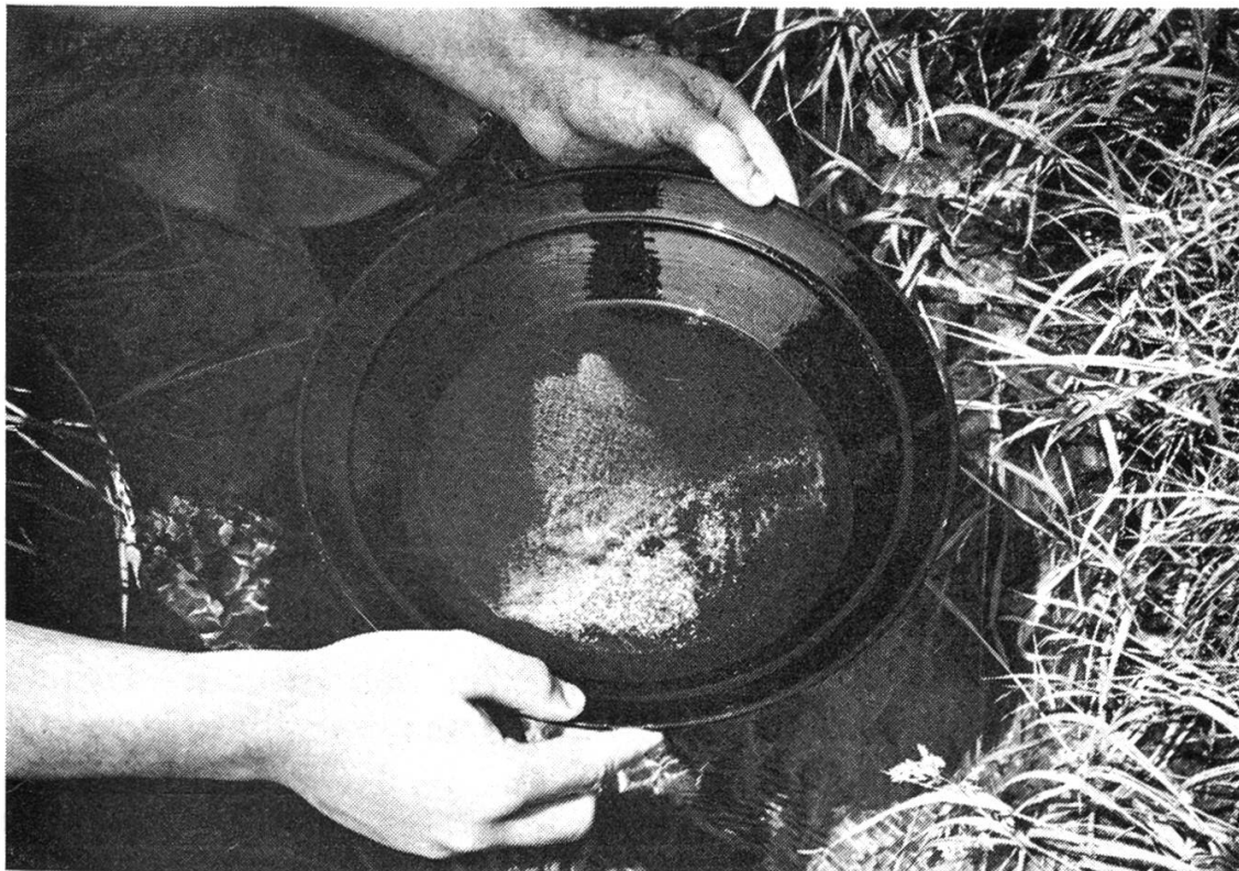
Abb. 2: Klassische Goldwaschpfanne mit flachem Boden und schräger Seitenwand, mit Schwermineral-Waschkonzentrat zu Ende eines Waschzyklus. Pfanne eines Herstellers aus dem Napfgebiet.
