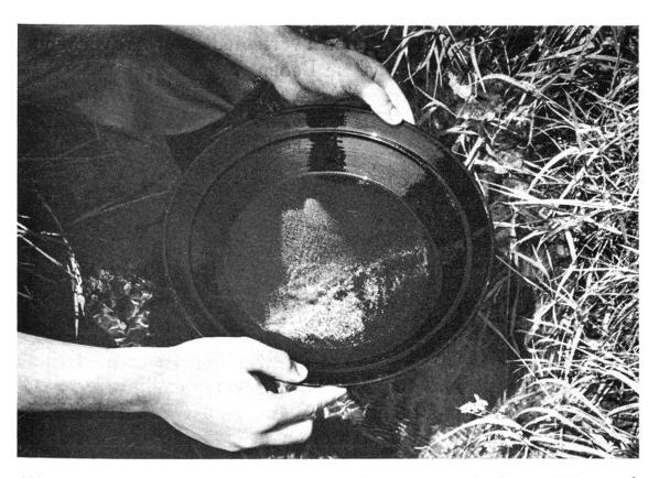
Abb. 2: Klassische Goldwaschpfanne mit flachem Boden und schräger Seitenwand, mit Schwermineral-Waschkonzentrat zu Ende eines Waschzyklus. Pfanne eines Herstellers aus dem Napfgebiet.
