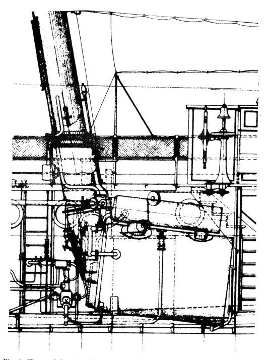
Fig. 4: Flammrohrkessel-Aufriss. (Zeichnung Gebr. Sulzer, Winterthur, 1891)
